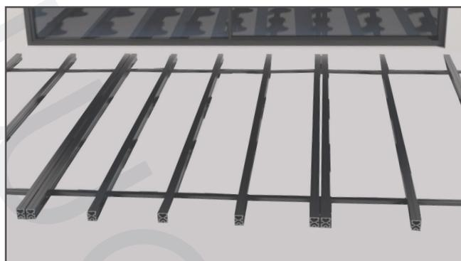
Fixer d'abord les répartiteurs extérieurs aux lambourdes du cadre sur les 4 coins de la terrasse. Pour les fixer, utiliser les Lockers et TC Fix pour les bloquer des 2 côtés de chaque lambourde. Placer le répartiteur à 250mm de l'extrémité de la lambourde pour laisser la place au plot extérieur.
