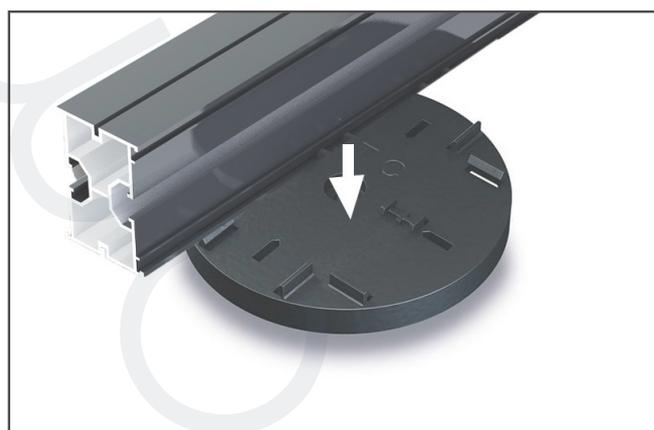
**ENTRAXE DES SUPPORTS** : Les supports doivent être positionnés à un **entraxe maximal de 700 mm**. L'entraxe se calcule de centre à centre des supports.
