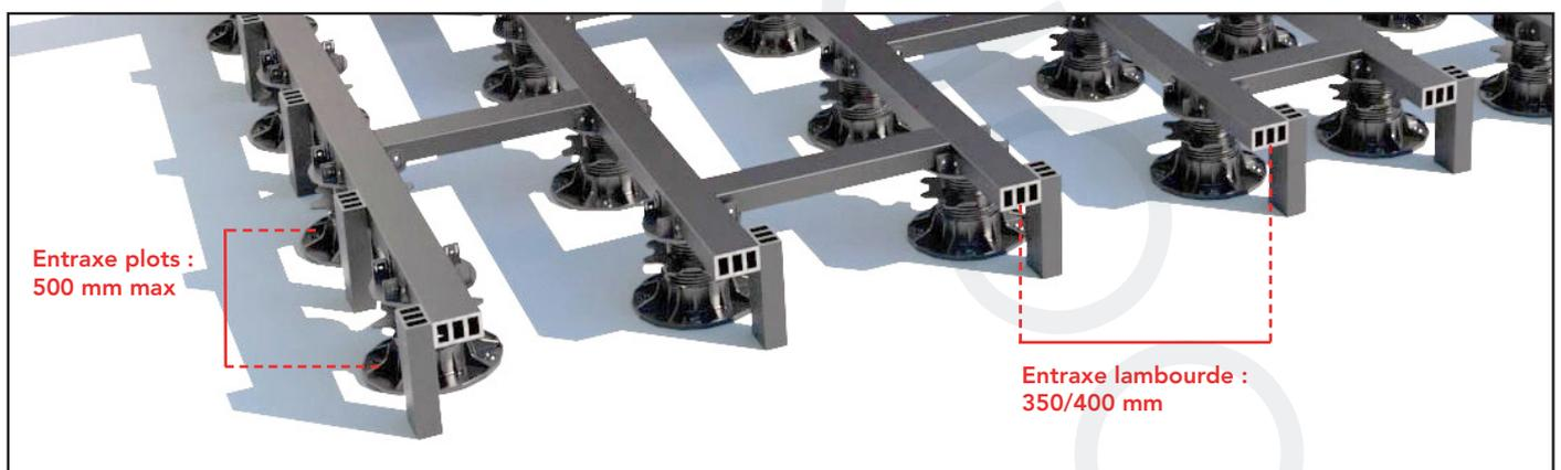
**ENTRAXE DES SUPPORTS** : Les supports doivent être positionnés à un **entraxe maximal de 500 mm**. L'entraxe se calcule de centre à centre des supports.
